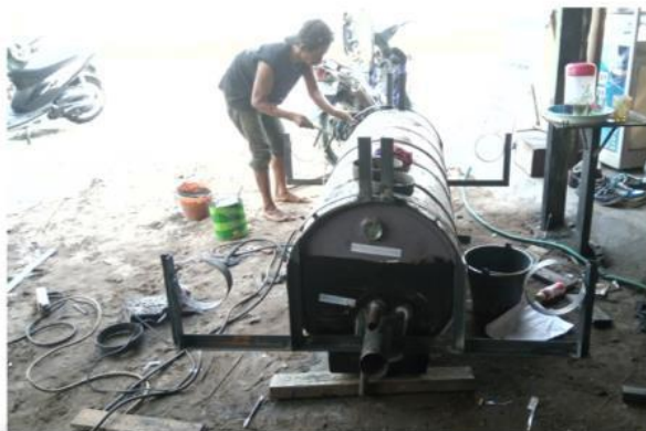
Gambar 5. Merupakan proses pembuatan septictank terapung
