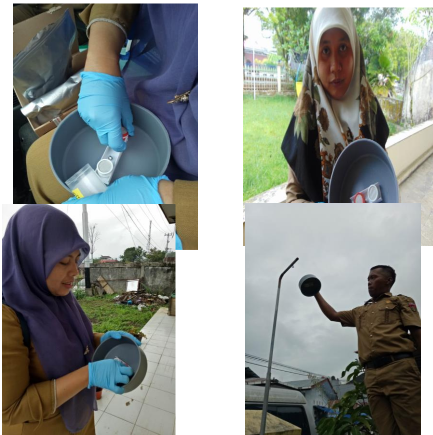
Pengukuran Kualitas Udara Ambien dengan Metode Passive Sampler
