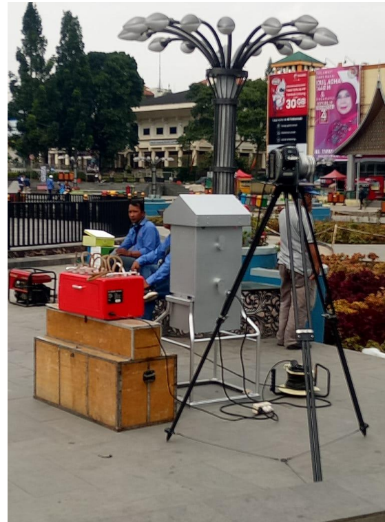
Pengukuran kualitas udara ambien di Jam Gadang Kota Bukittinggi dengan metode manual aktif
