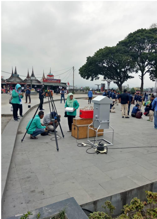
Pengukuran kualitas udara ambien di Jam Gadang Kota Bukittinggi dengan metode manual aktif
